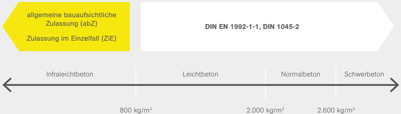
Abb. 3: Unterscheidung von Beton nach der Rohdichte; genormter und nicht genormter Bereich der Rohdichte für Beton und Stahlbeton
